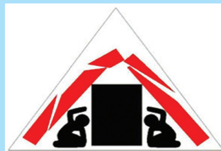
Lám. 16: Triángulo de la vida. Es el espacio triangular que se forma entre un mueble fuerte como un escritorio o un lavadero y una pared caída.
