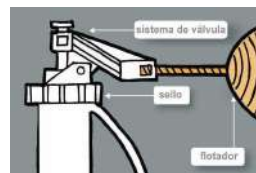
Accesorios al interior del tanque
