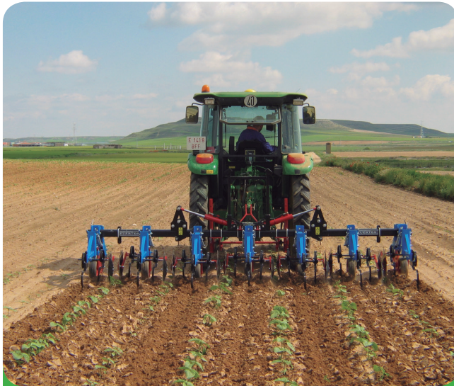
| Equipo agrícola. Aparatos diseñados | | para abrir surcos en la tierra, | | desmenuzar, fumigar y fertilizar en el | | suelo |
