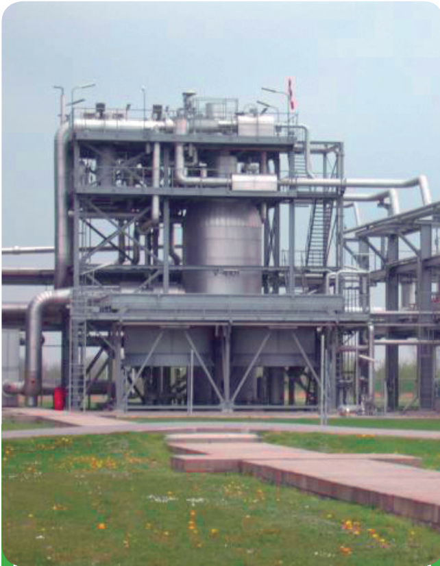
Precipitadores electrostáticos, plantas anticontaminación que filtra el aire en las plantas de sinterización al procesar el acero. Brasil.
