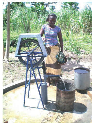
Extracción de agua con bomba de mecate
