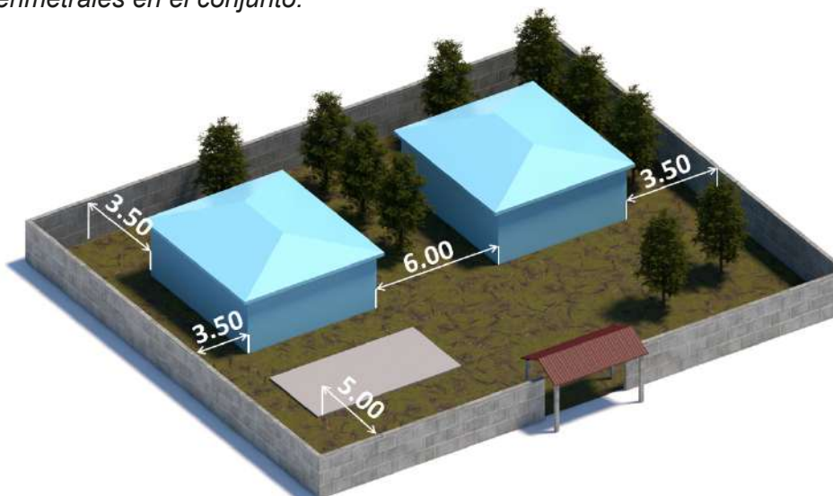
Figura 3 Retiros perimetrales en el conjunto.
