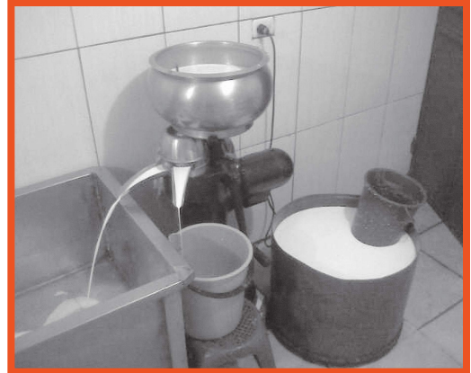
Fig. 70. Proceso de descremado mecánico.
