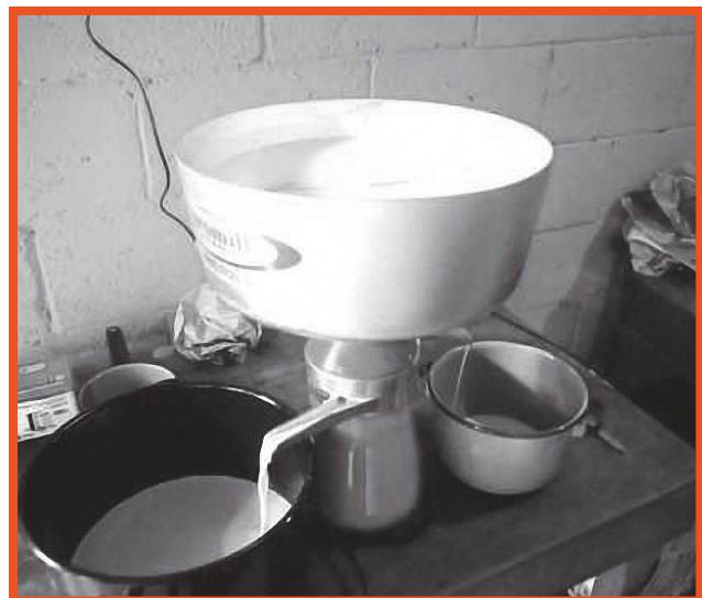
Fig. 68. Procedimiento del descremado de la leche.
