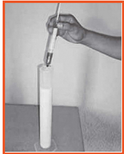
Paso 3: Introduciendo lactodensímetro en la probeta.
