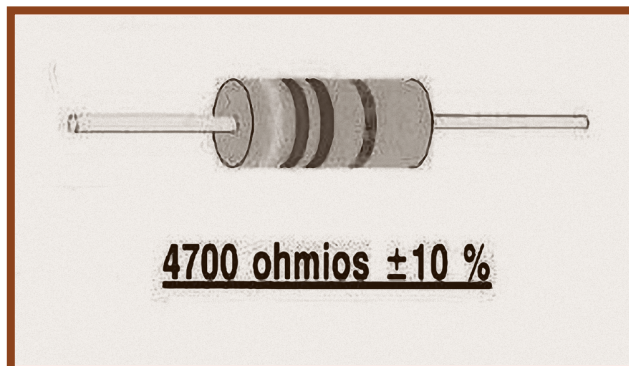
Figura N° 19. Resistencia fija con anillo de colores
