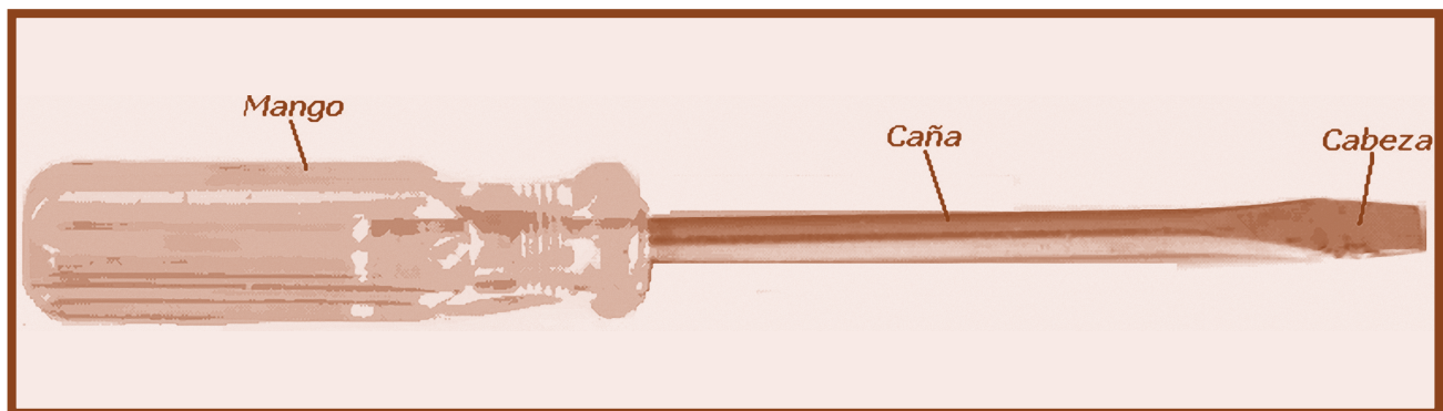
Figura N° 119. Estructura de un destornillador
