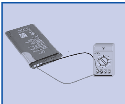
Figura N° 48. Midiendo tensión eléctrica.
