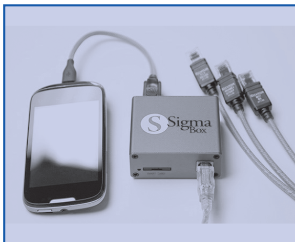
Figura N° 62. Caja de flasheo
