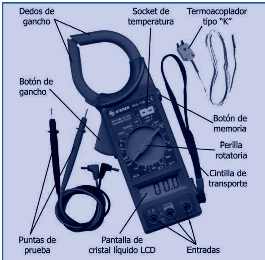
Figura N°35. Estructura del multímetro de gancho digital.
