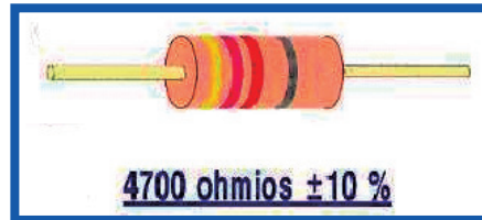
Figura. N° 11. Resistencia fija con anillo de colores
