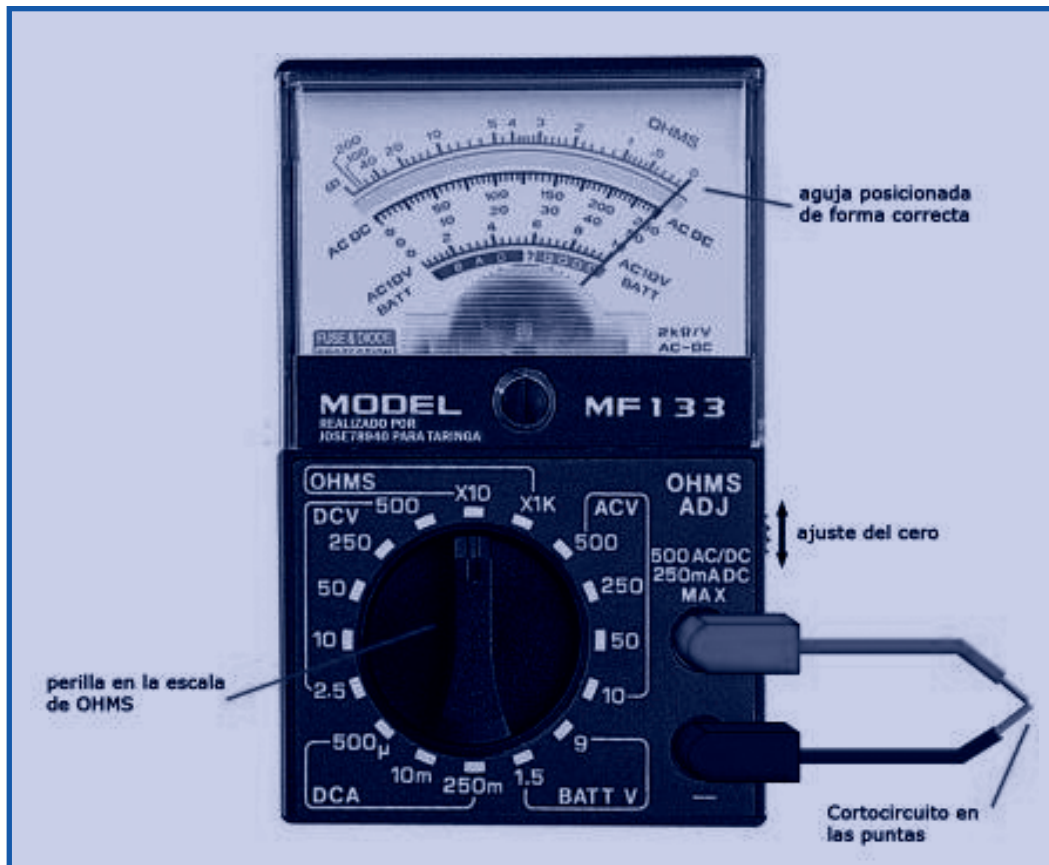
Figura N° 37. Ajuste del cero Ohm.
